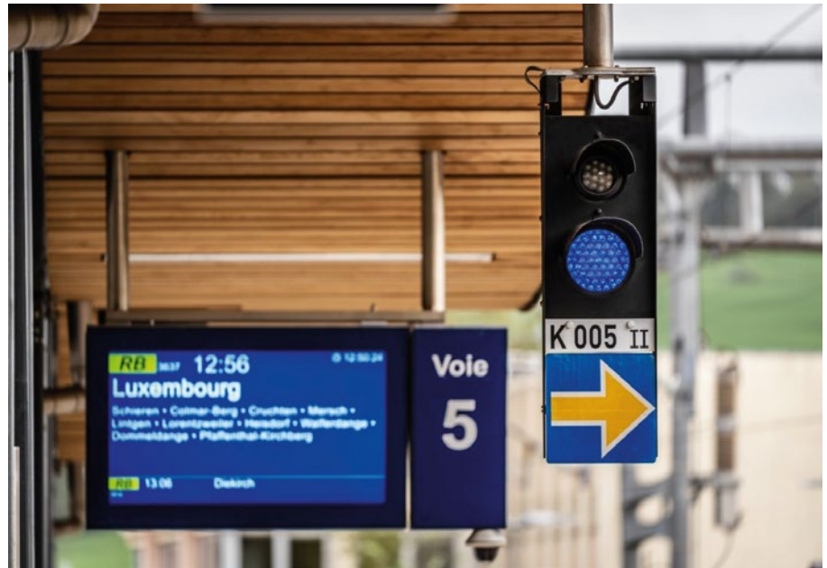
1: Haltzeigendes Einheitslichtsignal mit ETCS Stop Marker, hängend
